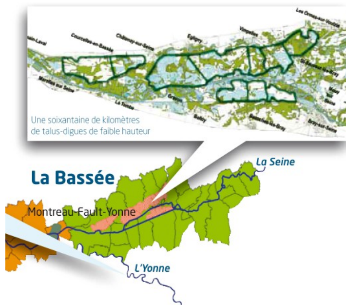
Illustration 22 : Localisation et schéma de principe des ouvrages de la Bassée. Source EPTB SGL.
