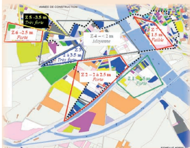
Synthèse de la vulnérabilité structurelle de l'habitat.
